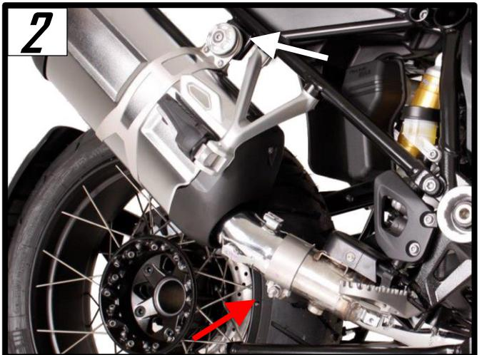
Lösen Sie die Schrauben des Halters und der Schelle.
