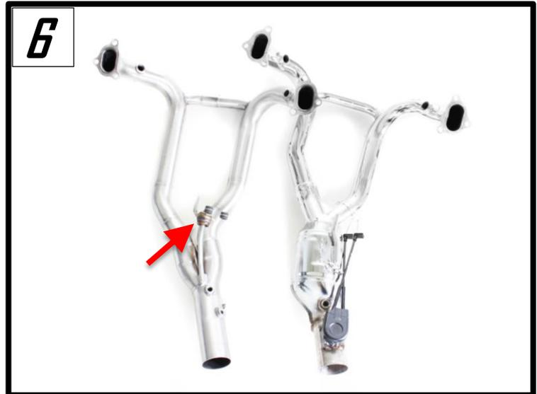
Montieren Sie den Remus Krümmer und befestigen Sie alle Schrauben und Muttern des Krümmers, sowie die Lambdasonden. (Abb. 7/8)
